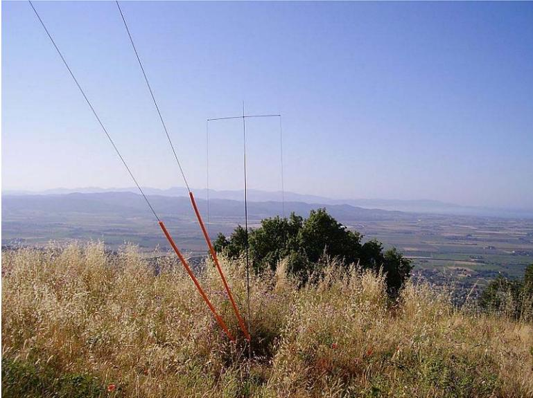
Prove sul campo effettuate sulle alture livornesi, in JN53HC, hanno permesso, in fase di paragone con una tre elementi a boom corto, del guadagno di 5,5 dBd, un immediato collegamento in SSB con la stazione inglese M0AEP, situata nel locatore IO93SO, con la potenza di uscita del mio FT817 regolata a **500 milliwatt**.
